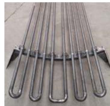
Serpentina riscaldante realizzata su misura fissata all'interno del serbatoio per mantenere una temperatura minima di utilizzo.
